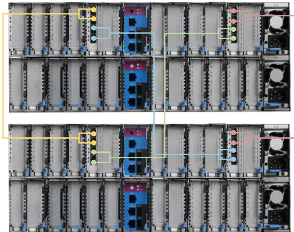
图 2-5 NTB 卡四控连接（单端口线缆方式）
