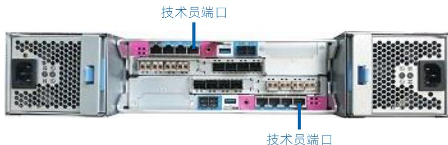
图 3-10 技术员端口（4U 控制柜）
